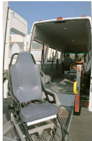
Sprinter mit Rollstuhl-Lift
