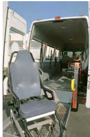
Sprinter mit Rollstuhl-Lift
